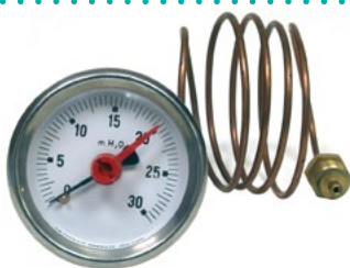
Hidrometro con bulbo y capilar IMIT Escala 0 a 30mca . Diametro 57mm , capilar 1,5 metros
