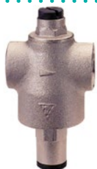
Válvula reductora de presión de latón, marca RINOX, rosca 3", presión máxima entrada: 16 bar, presión de salida regulable de 1-6 bar
