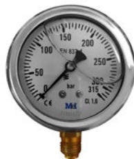
Manómetro glicerina MEI Ø63mm vertical 1/4" 0 a 315bar
